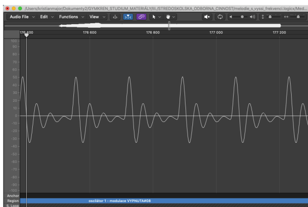
Obr. 34: Průběh zvuku oscilátoru 1 s vlivem rezonance
