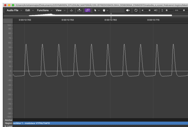
Obr. 35: Průběh zvuku oscilátoru 1 bez vlivu rezonance
