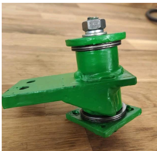
Obrázek 29 Celé ložisko po vyztužení, svaření a nalakování.
