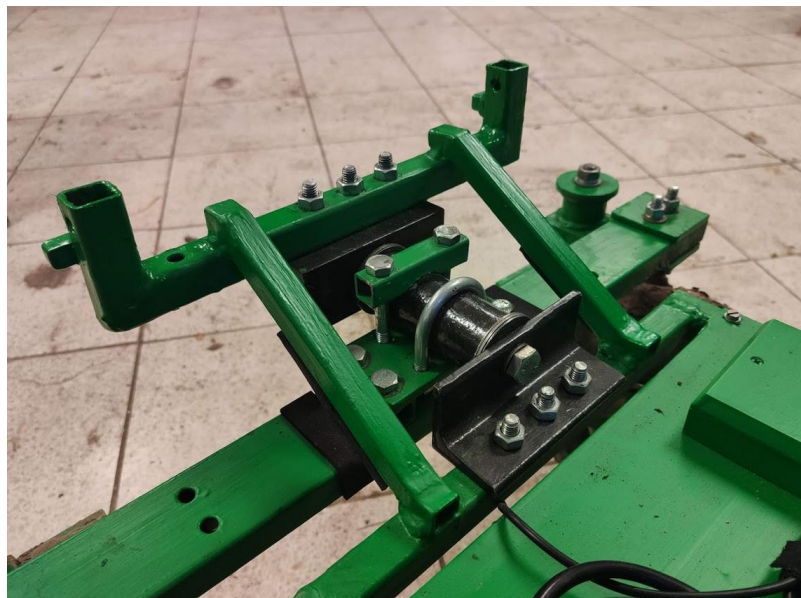
Obrázek 32 Ložisko pro výkyvný pohyb přední nápravy
