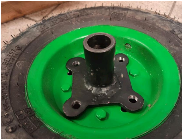
Obrázek 21 Kolo a příruba na výstupní hřídel převodovky
