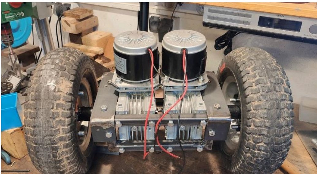
Obrázek 24 Převodovky přichycené k rámu s koly. Původní pláště, které byly později nahrazeny jinými. Pozn. Foceno ještě před nalakováním.
