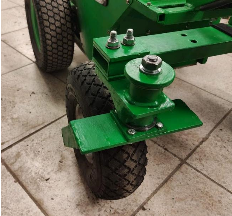
Obrázek 31 Uchycení kola k ložisku a přední nápravě
