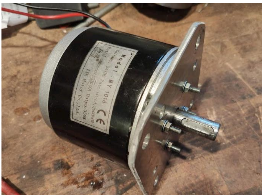
Obrázek 18 Motor s jeho hliníkovou přírubou a obrobkem na hřídeli, umožňujícím přenos točivého momentu do převodovky
