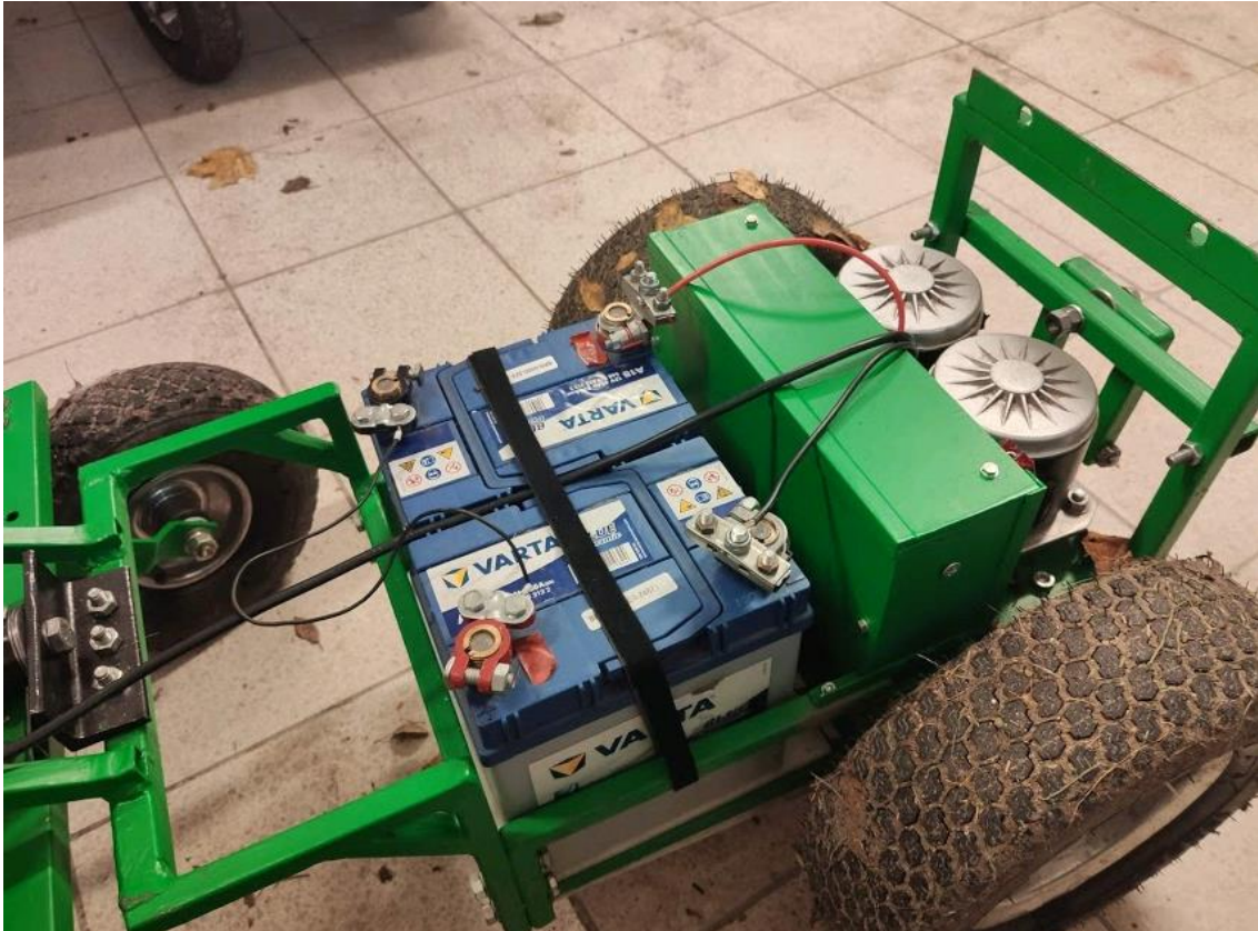
Obrázek 33 Rám vozidla (ještě s původními Varta akumulátory, které byly nahrazeny CSB akumulátory)
