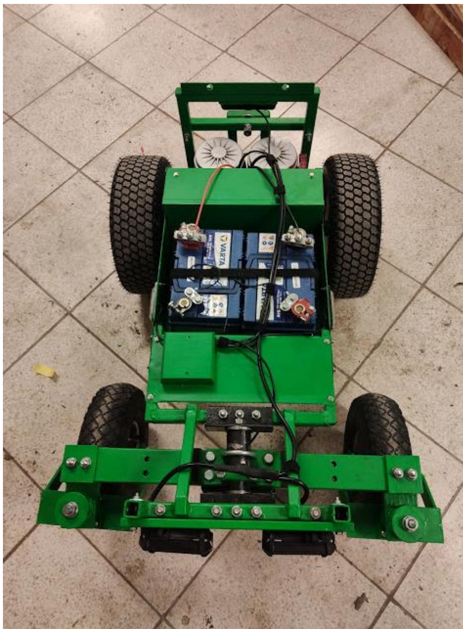
Obrázek 34 Celkový pohled zepředu na vozidlo bez korby (ještě s původními Varta akumulátory, které byly nahrazeny CSB akumulátory)
