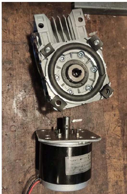
Obrázek 20 Motor a převodovka. Na přírubě převodovky lze vidět použité silentbloky a gumové těsnění.
