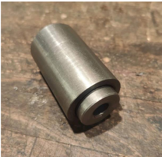
Obrázek 27 Silnostěnné trubky padnoucí do sebe
