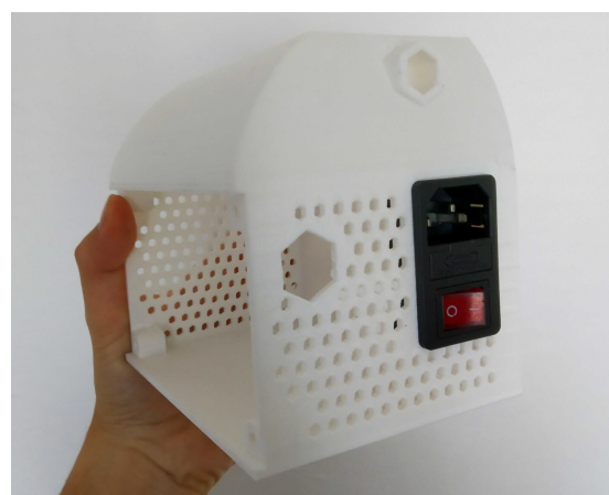
(b) Box pro elektroniku se síťovou zástrčkou, vypínačem a pojistkou
