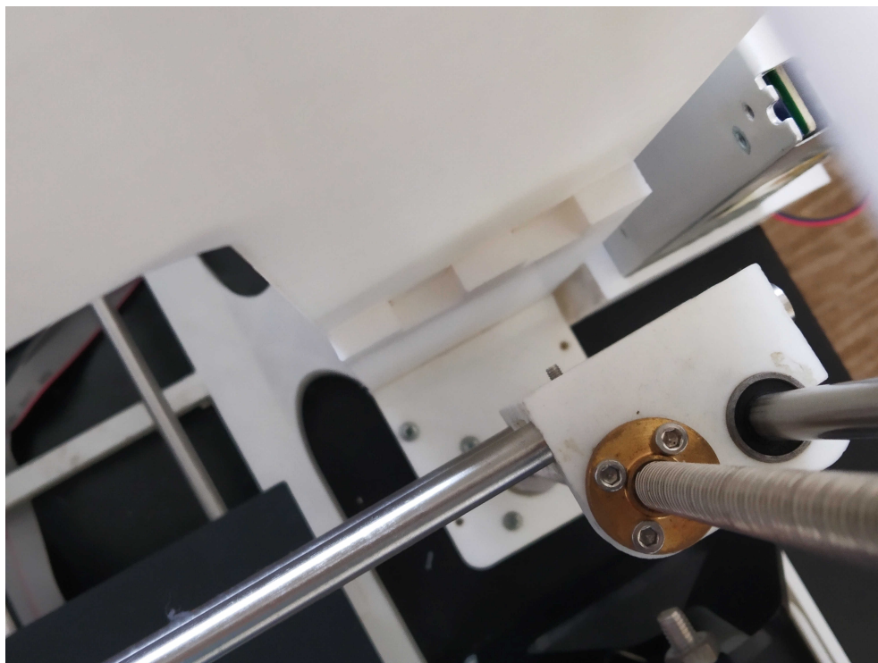
Obr. 4.2: Odchylka znemožňující fixaci dílů šrouby
